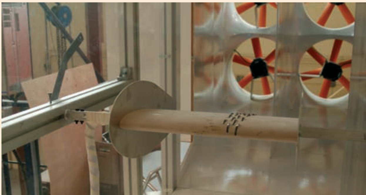
Interior del túnel de viento, donde se prueban los perfiles.
